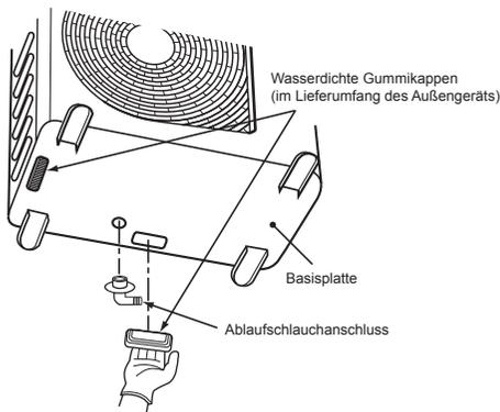
2. Installieren Sie den Ablaufschlauchanschluss und einen im Handel erhältlichen Kondensatschlauch (mit einem Innendurchmesser von 16 mm) und lassen Sie das Wasser ab. (Informationen zur Installationsposition des Ablaufschlauchanschlusses finden Sie im Installationsdiagramm der Innen- und Außengeräte.)
