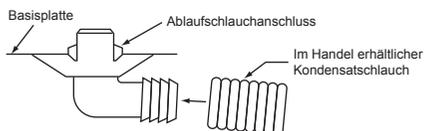
Verwenden Sie keinen normalen Wasserschlauch, da sich dieser flach drücken und verhindern kann, dass Wasser abläuft.
