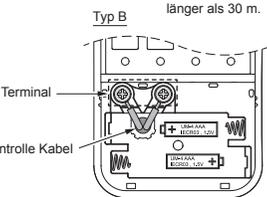
\* Die Anschlussklemmen für die Verdrahtung können sich entweder rechts (Typ A) oder links (Typ B) befinden, je nach dem im Karton verpackten Steuergerät.
