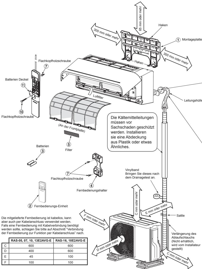
Für die hinteren linken, unteren linken und linken Rohrleitungen
