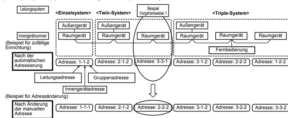
Die obige Adresse wird von der automatischen Adressierung eingestellt, wenn der Strom eingeschaltet wird. Leitungs- und Innengeräteadressen werden jedoch zufällig eingestellt. Ändern Sie daher die Einstellung so, dass die Leitungsadressen mit den Innengeräteadressen übereinstimmen.
