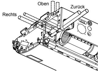
\* Wenn die Kondensatpumpe (nicht im Lieferumfang enthalten) installiert ist, kann die Kältemittleitung nur nach oben herausgenommen werden.
