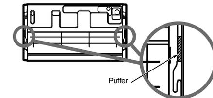
Puffer werden für den Transport zwischen der Hand und nehmen Sie das Lufteinlassgitter mit der anderen Hand heraus. Drücken Sie dabei vorsichtig darauf. (Es gibt zwei Lufteinlassgitter.) Entfernen Sie sie vor der Installation.
