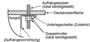
\* Befestigen Sie den Hängebügel wie unten dargestellt bei nach oben gebogener Decke, wenn sie flachere Muttern am Hängebügel befestigen.
