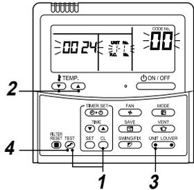
**1** Drücken Sie die Tasten **UNIT LOUVER** und **TEST** gleichzeitig mindestens vier Sekunden lang, um den Servicemode aufzurufen.
