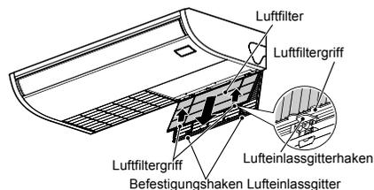
**4 Reinigen Sie ihn mit Wasser oder einem Staubsauger.**
