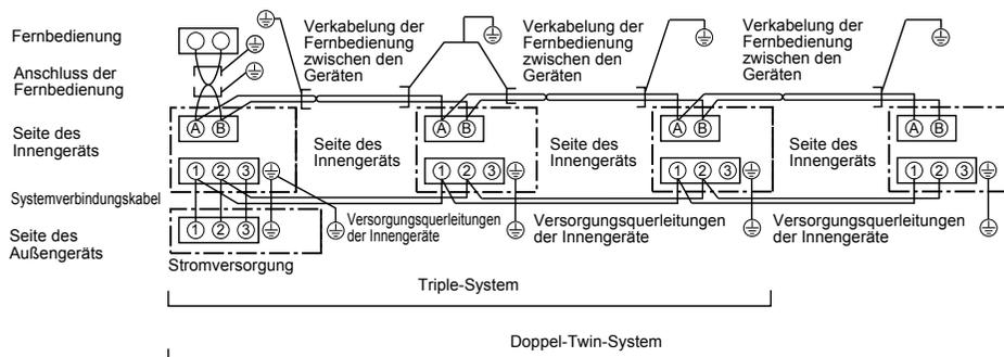
\* Um Rauschstörungen auszuschließen, verwenden Sie zur Verdrahtung der Fernbedienung mit dem simultanen Twin-, simultanen Triple- und simultanen Doppel-Twin-System ein 2-adriges geschirmtes Kabel (MVVS 0,5 bis 2,0 mm<sup>2</sup> oder mehr). Verbinden Sie beide Enden der Abschirmung mit Erdkontakten.
