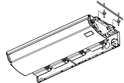
3 Befestigen Sie das Deckenmaterial sicher mittels der Doppelmutter, wie in der Abbildung unten gezeigt.
