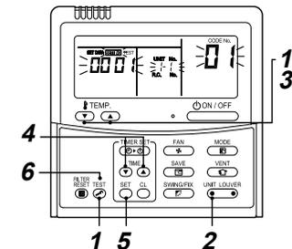
1 Halten Sie die Tasten **TEST** und „TEMP.“ gleichzeitig mindestens 4 Sekunden lang gedrückt. Nach kurzer Zeit blinkt das Display wie in der Abbildung dargestellt. Stellen Sie sicher, dass die CODE No. [01] lautet.
