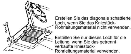
Passen Sie nach Anbringen der Leitung die beigefügte Wärmedämmung der oberen Platte an die Form der Leitung an, und dichten Sie anschließend das Loch ab.
