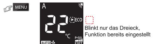
3. Verlassen Sie die Anzeige der Menüeinstellung durch Auswahl von EXIT.
