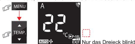
2. Wechseln Sie in die LEISTUNGS-AUSWAHL-Einstellung, indem Sie die MENU-Taste erneut drücken.
